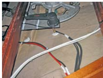
Här ses insidan på jordplattan med sina anslutningar. Fick lite bekymmer när jag skulle dra kraftmatningen från vindgeneratorn ihop med den hemmabygga kondensatorn, men det var OK enl. SRS. (Eventuellt kunde generatorn brinna upp!)
