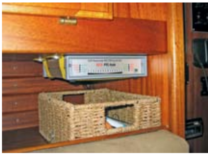
Upphängningen består av vanliga band som är fastskruvade under överskåpet.
